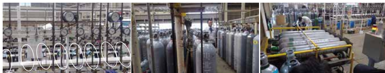
図5 高圧ガスの充填の様子。白丸で囲ったのが充填中の酸素ポンベ。何本ものポンベを並べてから各々のポンベに治具を取り付けて、同時に混合ガスを充填していた。使用者の注文で作製される混合ガス（例えば水素 5%+窒素 95%など）は、充填時にはガスを充填した順番に層状に別れてしまうため、充填後にポンベを回転させて中のガスを均一化させる。
