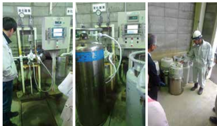
図4 液化ガスの充填の様子と医療用液化酸素容器。液化ガスは容器全体の重量を計りながら充填を行う。医療用液化酸素容器は在宅患者が使用する酸素供給用で容器上部が蒸発器になっている。
