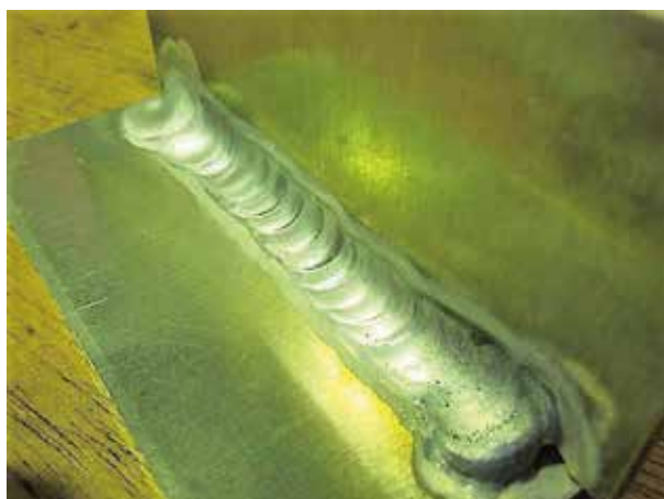
図6 溶接ビード外観（隅付け）
