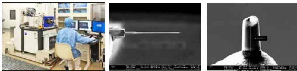
図 ZEISS製 N-Vision40 FIB/SEM装置 (左) 作製したTEM試料 (中) と透過X線分析用微細試料 (右)
