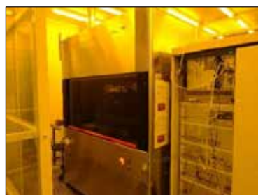
図 レーザー描画装置と作製した2.5インチクロムマスク
