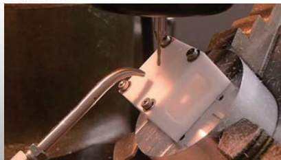
傾斜円テーブルと汎用フライスによる内テーパ加工(動画)
