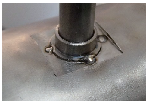
図 9 つば部分と本体部の溶接の様子
