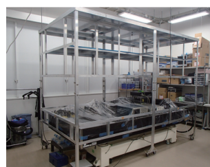
Alアングル溶接による 実験ブース製作
