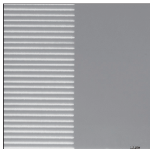
線幅 1 μm のライン&スペース
