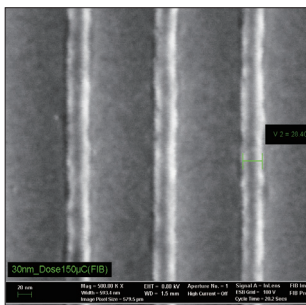
線幅 30nm のレジストパターン SEM 観察像
